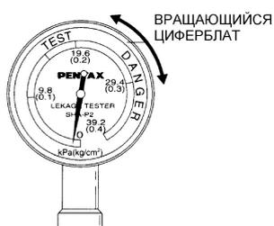
2. Поверните циферблат манометра так, чтобы стрелка показывала ноль.
