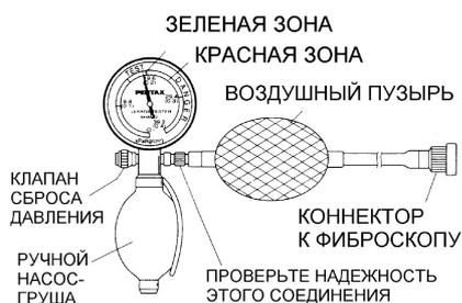
Герметичность эндоскопов Pentax можно проверить с помощью специального тестера герметичности. Процедуру проверки можно разделить на два этапа. Давление создается при помощи обыкновенной груши, без использования каких-либо электро-механических приспособлений.
