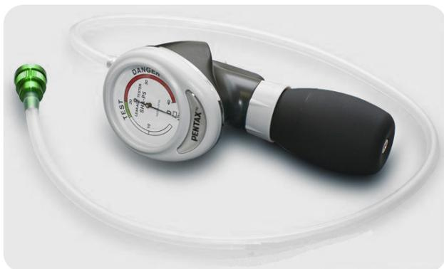
Тестер герметичности Pentax SHA-P5 применяется для проверки на дефекты внутренних каналов эндоскопа.
